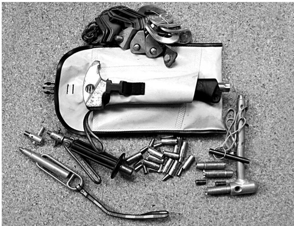
Obr. 360 Plakety, samořezné nýty různých typů a potřeby pro jejich ruční osazení
